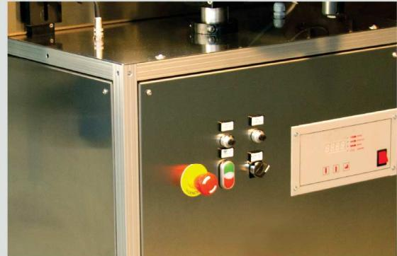
la testa viene controllata da una centralina con micro-processore integrato nel monoblocco, inclusa regolazione verticale testa tramite volantino.
